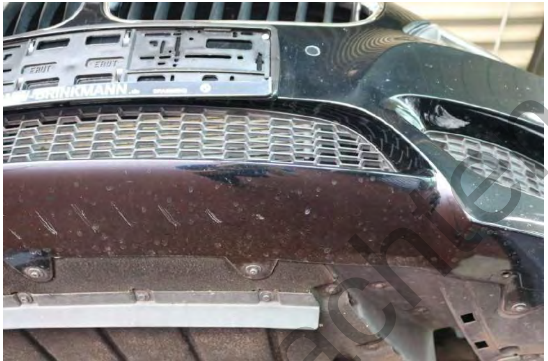
Bild 21: Mangel / Schaden – Karosserie Sicht - Motorhaube, Steinschlag
