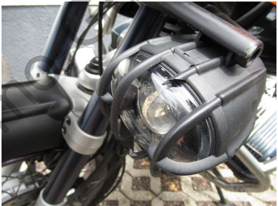
Bild 18: Rahmen Zusatzscheinwerfer links gebrochen
