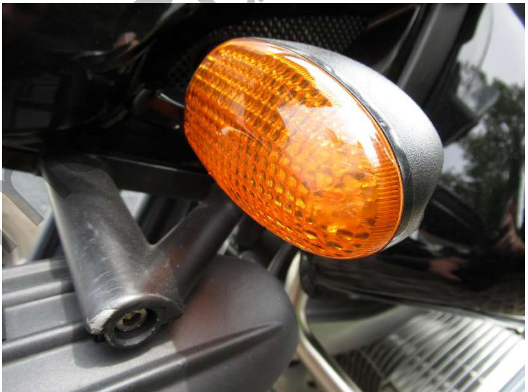
Bild 20: Kratzer Blinker vorne links
