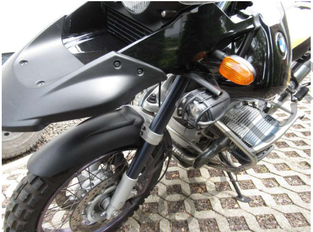
Bild 17: Rahmen Zusatzscheinwerfer links gebrochen
