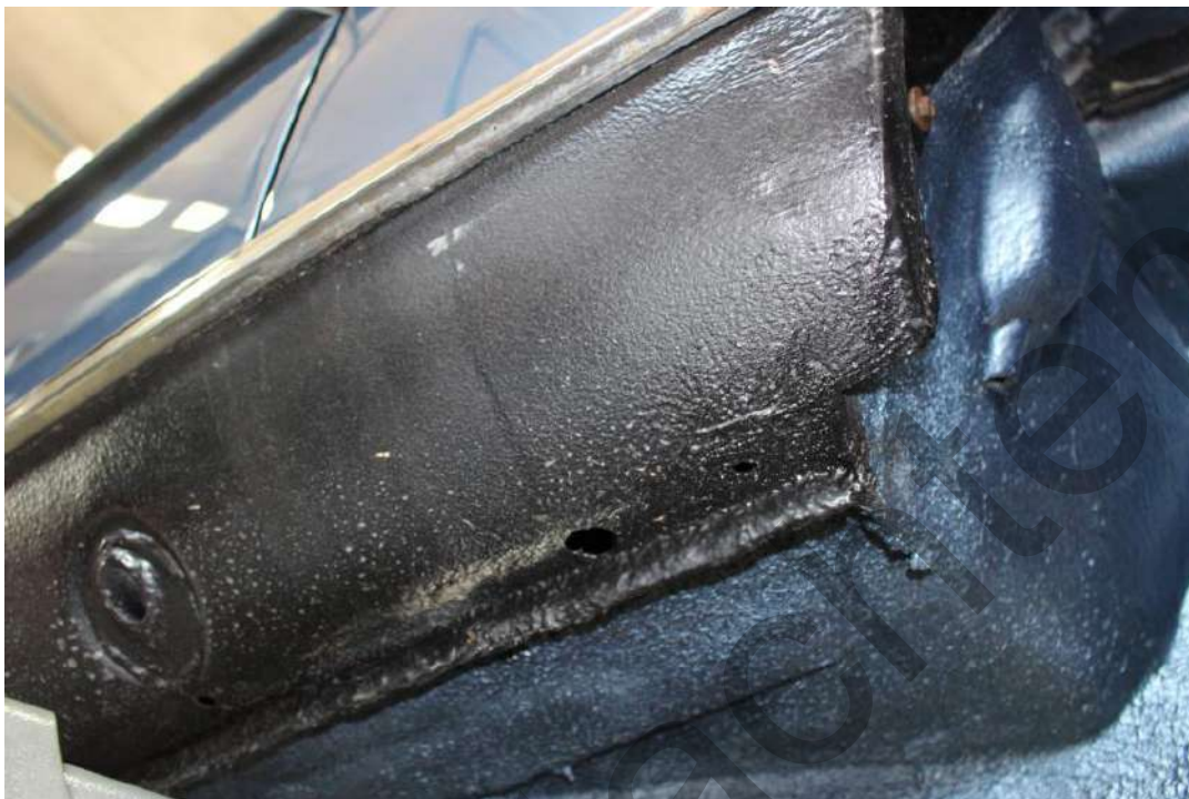
Bild 23: Unterboden – Abschürfung Unterbodenschutz Wagenheberaufnahmen
