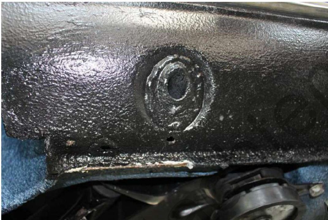
Bild 25: Unterboden – Abschürfung Unterbodenschutz Wagenheberaufnahmen
