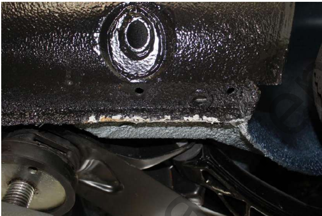
Bild 21: Unterboden – Abschürfung Unterbodenschutz Wagenheberaufnahmen
