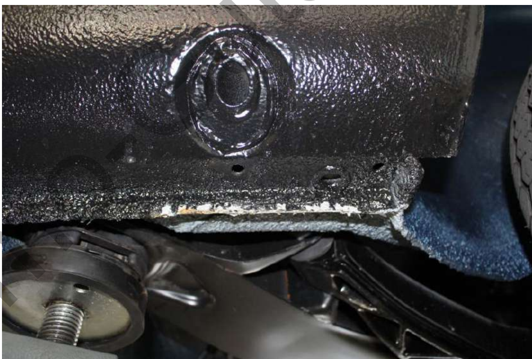
Bild 20: Unterboden – Abschürfung Unterbodenschutz Wagenheberaufnahmen
