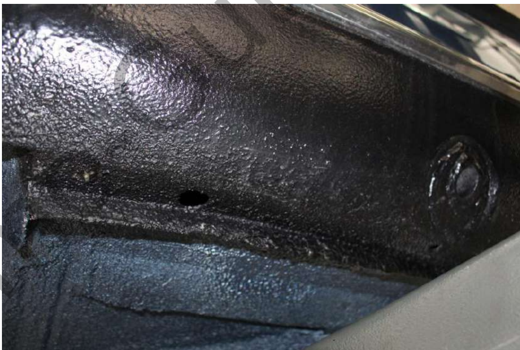
Bild 22: Unterboden – Abschürfung Unterbodenschutz Wagenheberaufnahmen
