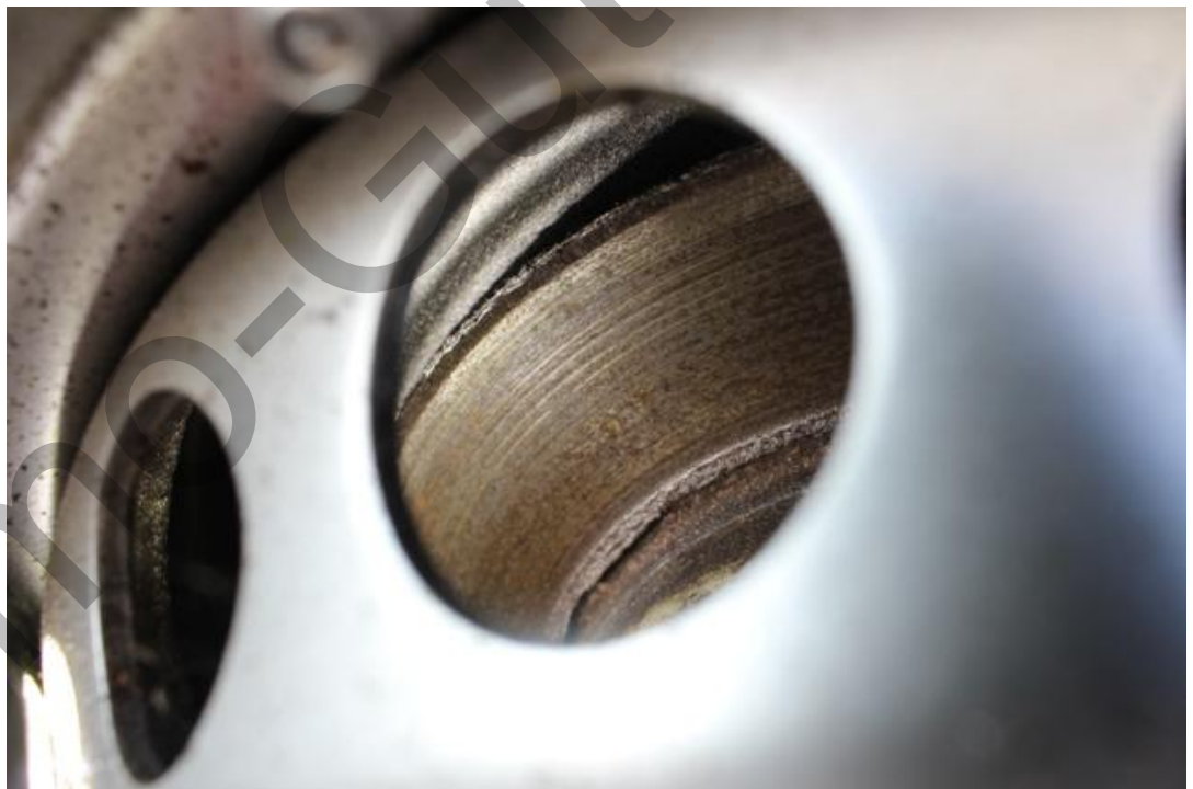
Bild 48: Mangel / Schaden – Unten Sicht (soweit prüfbar) - Bremscheiben, verschleißgrenze fast erreicht
